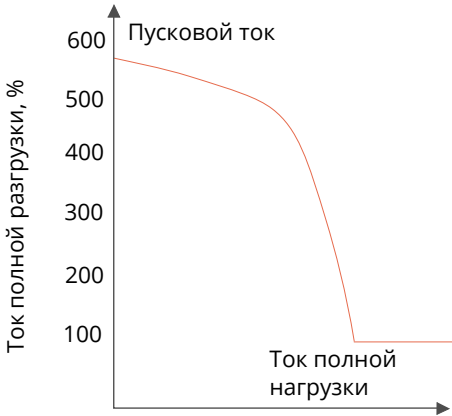
График изменения тока во время прямого пуска
